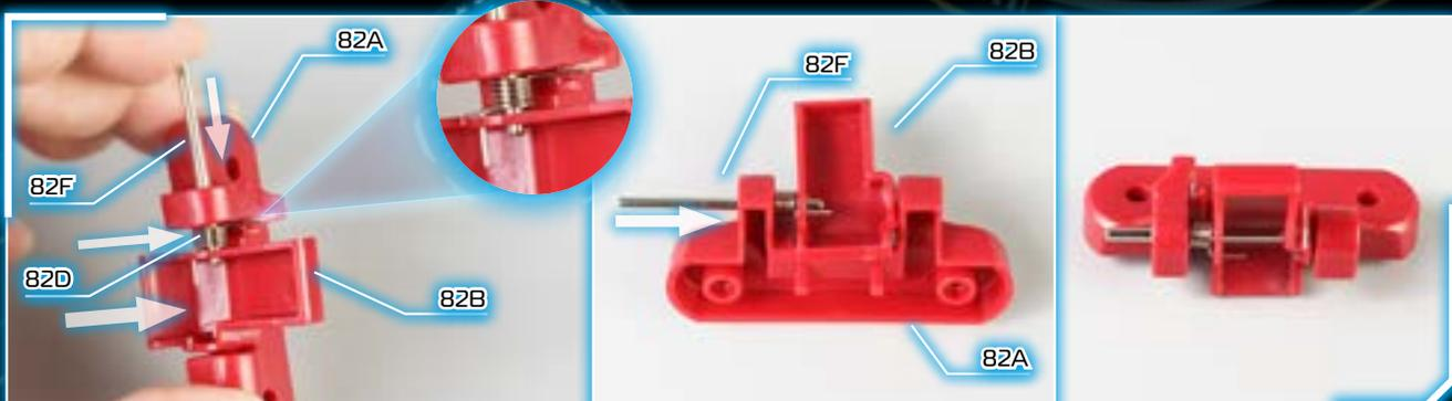
3 - Удерживая в руках деталь (82A), аккуратно установите на ней рычаг (82B) с пружиной (82D). Удерживая пружину на своем месте, протолкните ось (82F) так, чтобы она прошла сквозь пружину, рычаг и второе отверстие основания.
